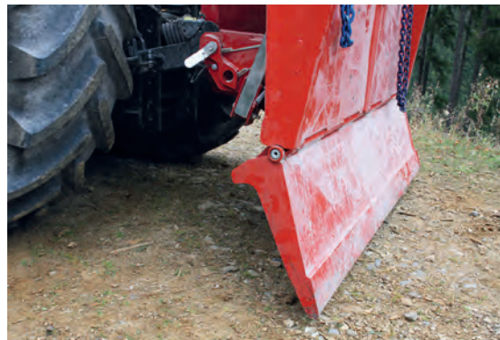
Das 2,02 m breite Rückeschild lässt sich hydraulisch schwenken.
