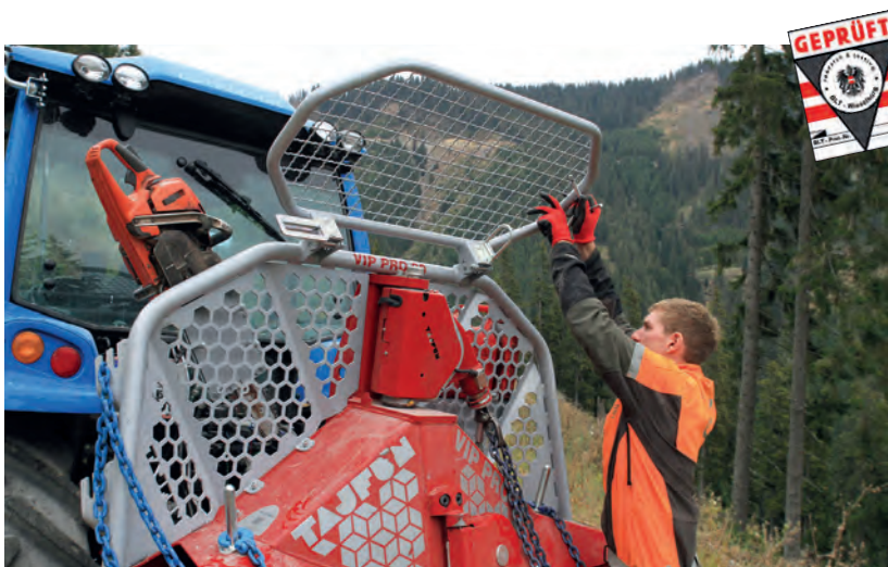
Das obere Schutzschild lässt sich mit wenigen Handgriffen herunterklappen.
