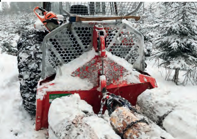
Auch unter härtesten Einsatzbedingungen machte die Winde eine gute Figur. Ist das Seil aber vereist, lässt es sich nicht mehr ausspulen.
